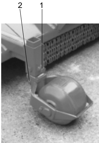
Abb.7: Laufrad HKP (Getriebe mittig)
